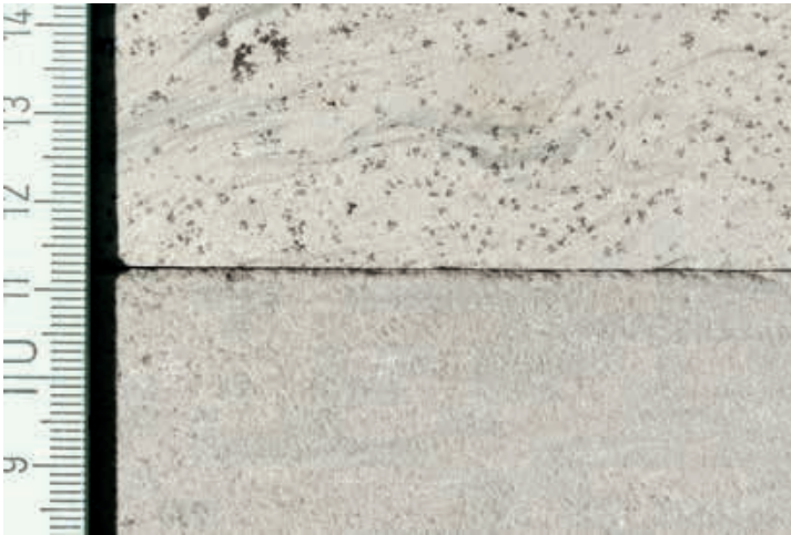
Abb. 8 Flasersandstein vom Steinbruch Am Eichberg bei Degerfelden (oben) und Flasersandstein aus der originalen Bausubstanz am Basler Münster (unten). Die Fleckung durch Mangan-oxide ist auch am Münster bisweilen anzutreffen, jedoch nicht ganz so ausgeprägt wie im dargestellten Probestück vom Eichberg. Die übrigen Merkmale stimmen überein: Korngrösse, -zusammensetzung, -verteilung und -bindung sowie die typische Einschaltung grünlicher Tonflaser mit unruhiger, geflaselter Textur. Foto Wolfgang Werner, 2019
