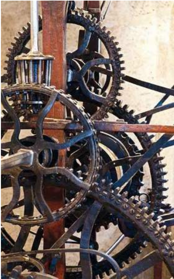
Zahnräder mit einzeln eingesetzten Zähnen
