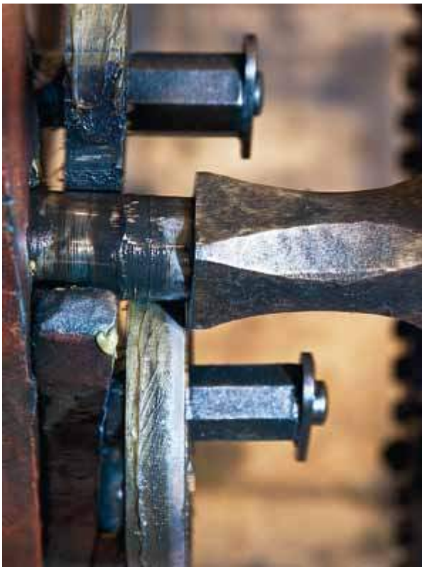
Lagerung der Walzenradwelle beim Gehwerk
