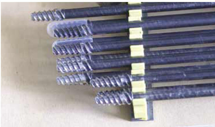
Detail aus dem Werkzeugkoffer: handbetriebene Hohlbohrer
